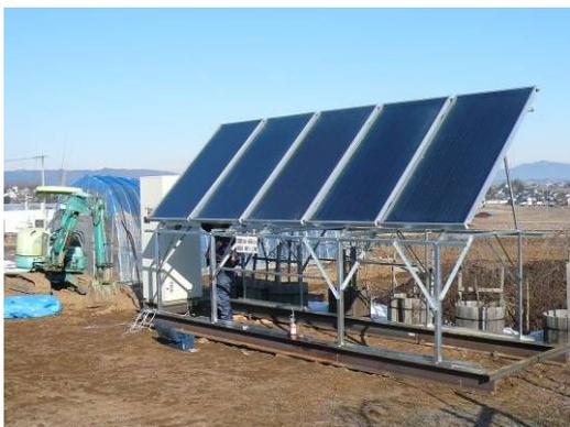
太陽熱と地中熱の融合によるビニールハウスへの熱供給の実験装置です。
