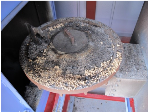
稲わらペレットの燃焼実験後のバーナー
