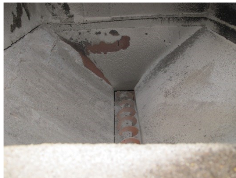
稲わらペレットの燃焼実験後のバーナー
